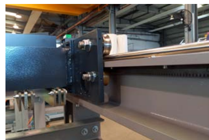
Βαρέως τύπου βάσεις (H) με σύστημα γранаζού - γραμμαριέρας (ATLANTA Γερμανίας). Ομαλή κίνηση χωρίς δονήσεις.
